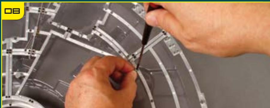
Закрепите соединительную накладку с двумя отверстиями на внутреннем ребре рамы TF-19, как показано.
