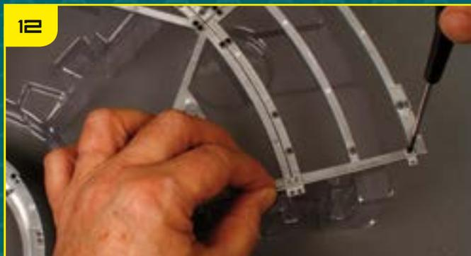
Закрутите крепежный винт во фланец ребра жесткости, как показано.
