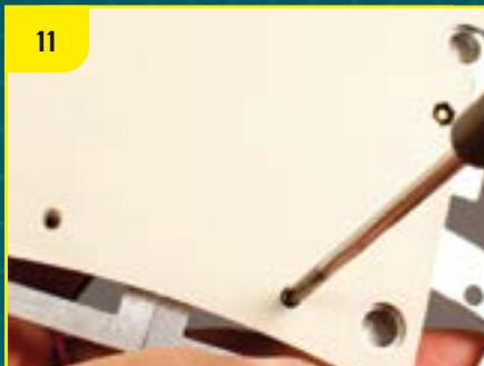
Зафиксируйте пластину, закрутив черные крепежные винты с полукруглой головкой в малые отверстия.
