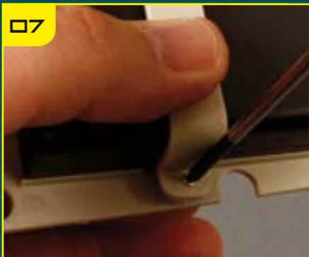
Убедитесь, что болт закручивается в гайку, и затяните его.
