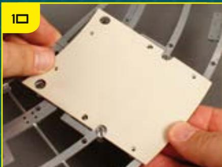
Сначала вставьте в вырез кабель с разъемом, затем расположите опорную пластину, как показано.
