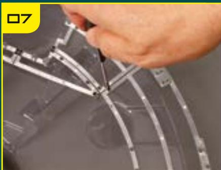
Зафиксируйте раму TF-19, закрутив винт во вторую соединительную накладку.
