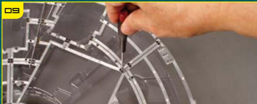
Совместите раму TF-20 с рамой TF-19 и зафиксируйте ее, закрутив крепежный винт в угловую соединительную накладку.
