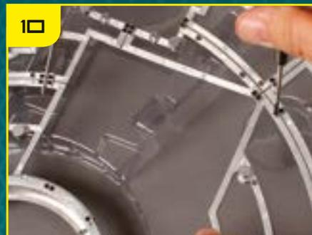
Зафиксируйте раму TF-20, закрутив винт в соединительную накладку, установленную на шаге 08.
